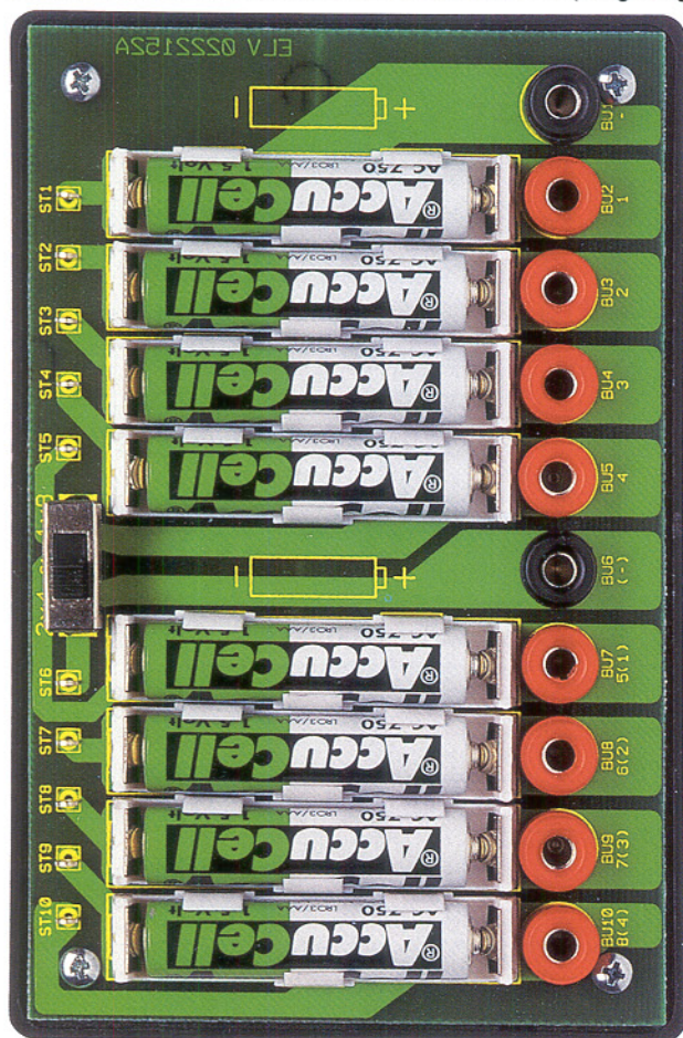
Ansicht der fertig bestückten Platine des Akku-Lade-/Speiseadapters mit zugehörigem Bestückungsplan, oben für Mignonzellen, unten für Microzellen (Originalgrößen: 135 x 90 mm)
