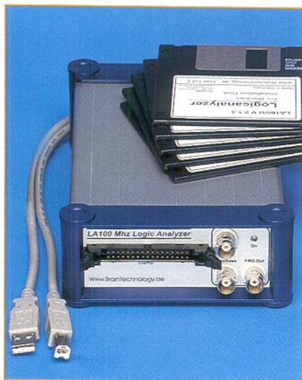
Bild 5: Arbeitet ebenfalls mit einer Version des diskutierten ActiveX: 16-Kanal-/100 MHz-Logik-Analyzator LA 100 USB.
