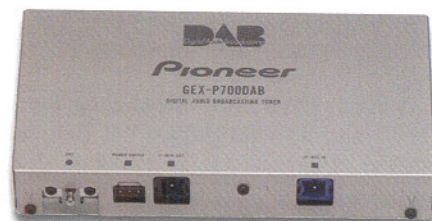
Bild 5: Mit solchen externen DAB-Boxen lassen sich viele vorhandene Autoradios mit DAB-Steuerung nachrüsten.
